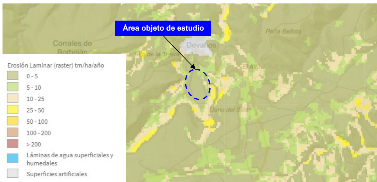
Ilustración nº 32: Caracterización de la erosión laminar en la zona.
